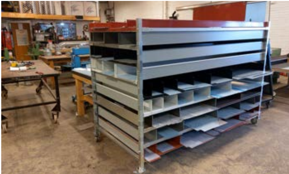
Sagen Blick AS hefur prófað þessa samsetningu sem millistöð fyrir úrgangsefni. Brotamálmur er flokkaður eftir litum og gerðum og er geymdur við hlið skurðarvélarinnar.
